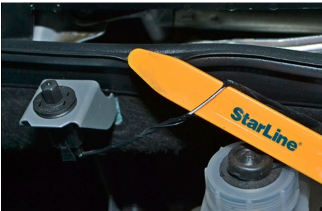
Фото 2.5. Концевик капота (бело-чёрный)
