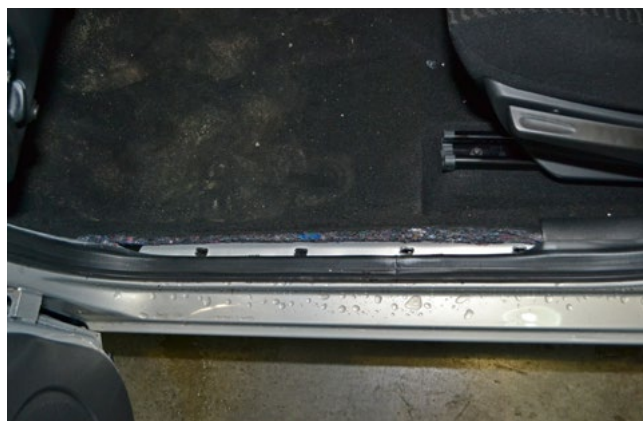
Фото 1.4. Накладка порога двери водителя снята
