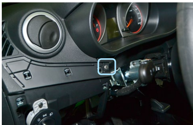
Фото 1.13. Нижний саморез крепления накладки панели приборов
