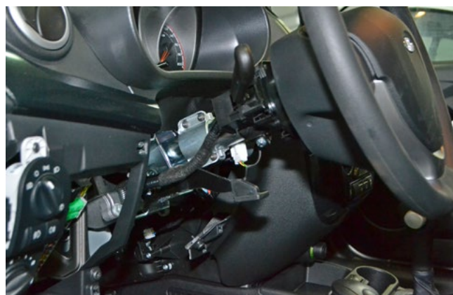
Фото 1.10. Кожух рулевого вала снят
