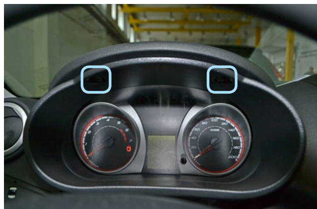
Фото 1.14. Верхние саморезы крепления накладки панели приборов
