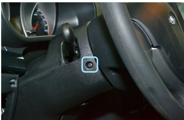
Фото 1.7. Саморез крепления нижней части кожану рулевого вала
