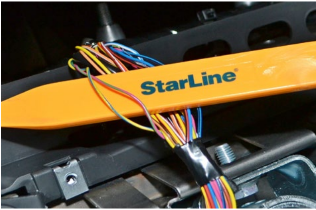
Фото 3.3. Шина CAN-A (розово-зелёный и жёлто-синий)
