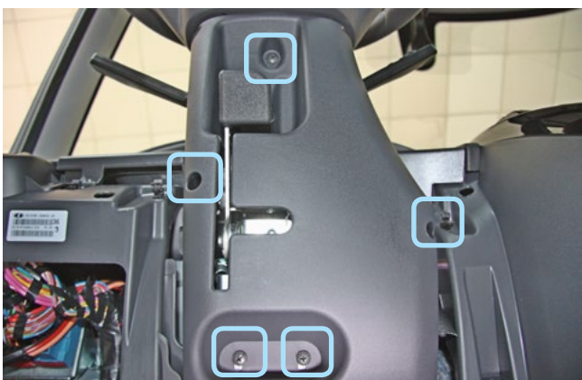
Фото 1.9. Крепление нижней части кожану рулевого вала
