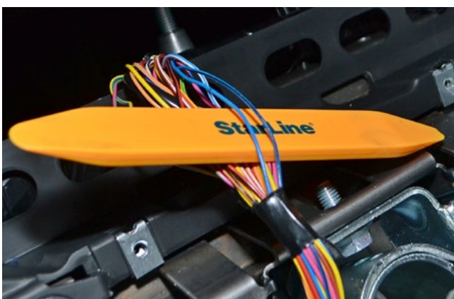
Фото 3.5. Управление световыми сигналами (синий и сине-чёрный)
