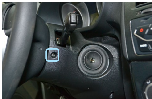
Фото 1.8. Саморез крепления нижней части кожану рулевого вала
