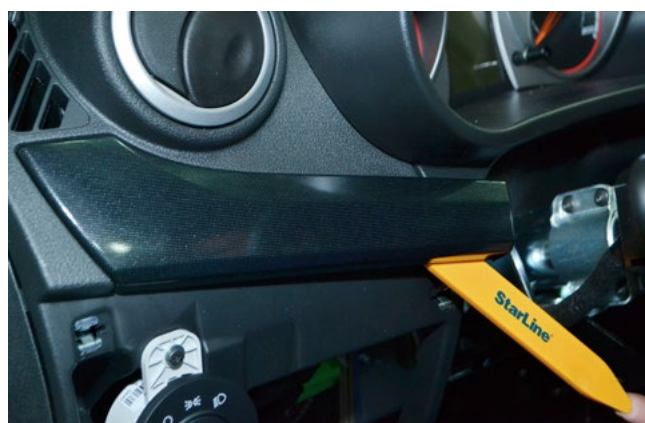
Фото 1.12. Снять декоративную накладку
