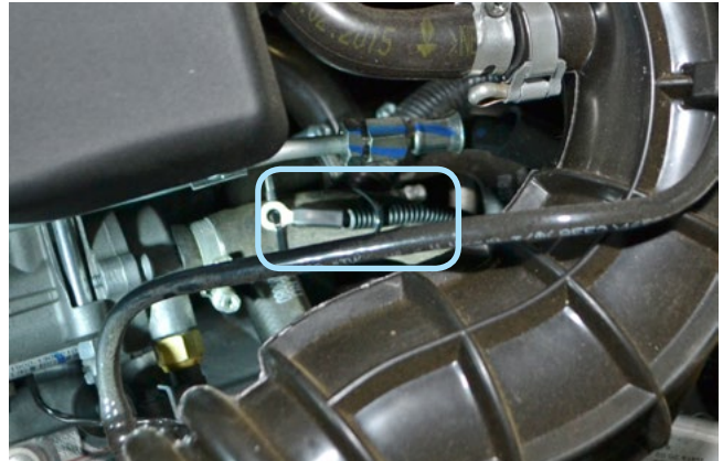
Фото 2.4. Крепление датчика температуры двигателя
